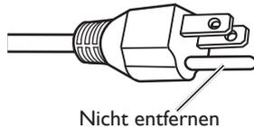
Dieses Gerät hat einen Schutzkontaktstecker. Setzen Sie die Erdung nicht außer Kraft. Aus Sicherheitsgründen passt dieser Stecker nur in eine geerdete Steckdose. Falls der Stecker nicht in die Steckdose passt, wenden Sie sich bitte an einen Elektriker.
